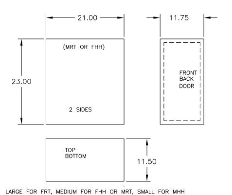
SEVEN RECTANGLES REQUIRED FOR A BOX. CUT OUT 1" BORDER ON FRONT (ONLY) TO MAKE DOOR FRAME TOP AND BOTTOM INSTALLED BETWEEN SIDES
